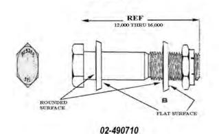
RECOMMENDED FLAT WASHER ORIENTATION AS SHOWN INSTALLATION TORQUE 285-300 FT LBS - TURNING THE NUT
